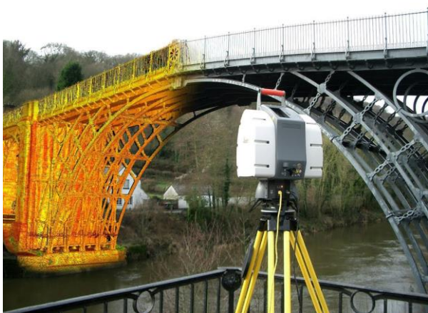
Рис. 2. 3D лазерний сканер для тривимірного лазерного сканування будівель та споруд
