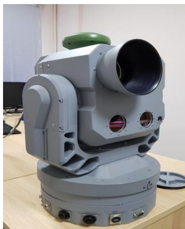
Рис. 1. Вариант внешнего вида опорно-поворотного устройства с опико-электронным модулем
