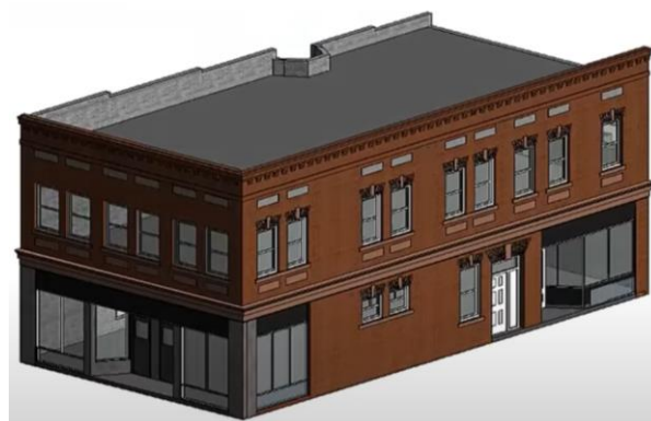
Рис. 3. Створення моделі на основі отриманої хмари точок а – процес створення моделі на основі отриманої хмари точок ; б – створена 3D-модель
