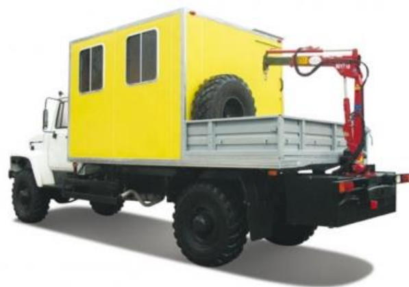
Рис.6. Аварійно-ремонтна майстерня з краном-маніпулятором
