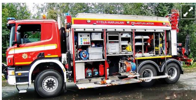
Рис.5. Великоваговий аварійно-рятувальний автомобіль Saurus RSC20 на шасі Scania P400 6×4/4100 CP28, призначений для роботи в зоні техногенних катастроф з КМУ Ferrari 714
